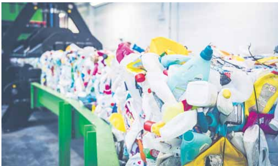
Automatická třídící linka umí separovat plast, papír a kovové obaly
